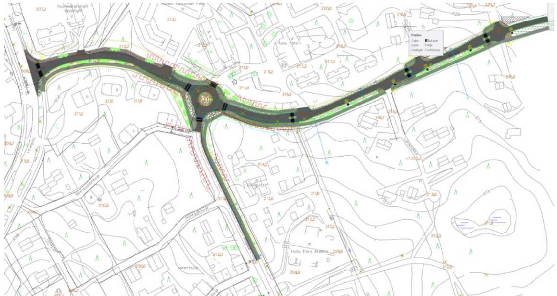
Kuva 15. Ote Rakkavaarantien peruskorjaussuunnitelmasta, jossa Hissitien itäpuolelle rakennetaan jalankulkuväylä puuttuvalle osalle katuosuutta. © FCG Suunnittelu ja Tekniikka Oy 2019.
